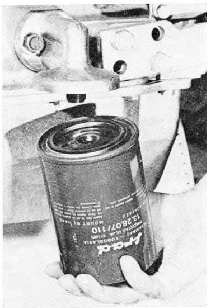
Slika 13a. Integralni prečistač ulja
