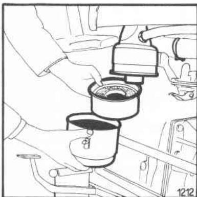
5. Prečistač vazduha, proveriti nivo i zaprljanost ulja, a po potrebi doliti ili zameniti ulje.
