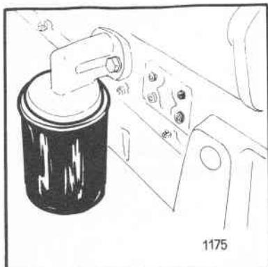
**2. Promeniti ulje u motoru:** Ulje ispustiti dok je motor topao, na taj način što treba odvrnuti čep na koritu motora i sačekati da se ulje iscedi. Treba upotrebljavati ulje prema sezoni rada, za to koristite tabelu preporučenih maziva.
